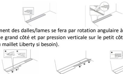
L'emboîtement des dalles/lames se fera par rotation angulaire à 25° en inclinant vers le bas sur le grand côté et par pression verticale sur le petit côté (à l'aide du roller à main ou du maillet Liberty si besoin).
